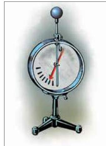
4.10. Электроскоп со стрелкой и шкалой (электрометр)
