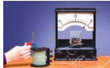
**1.5. Получение электрического тока с помощью магнита**
